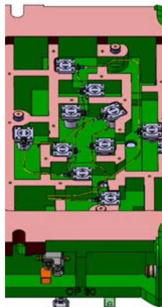
Montaggio del sensore sul complesso di controllo per il monitoraggio del sistema di connettori
