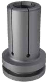
La géométrie peut être comparée à celle d'une douille fendue (semblable à une pince de serrage). Après la découpe proprement dite, le poinçon accompagné de la chute de poinçonnage plonge dans le DAE. Le DAE est alors élargi et appliqué sur le poinçon de découpe. Lors de la course de retour, le DAE enlève la chute de poinçonnage du poinçon protégeant ainsi l'outil et le produit de dommages.
