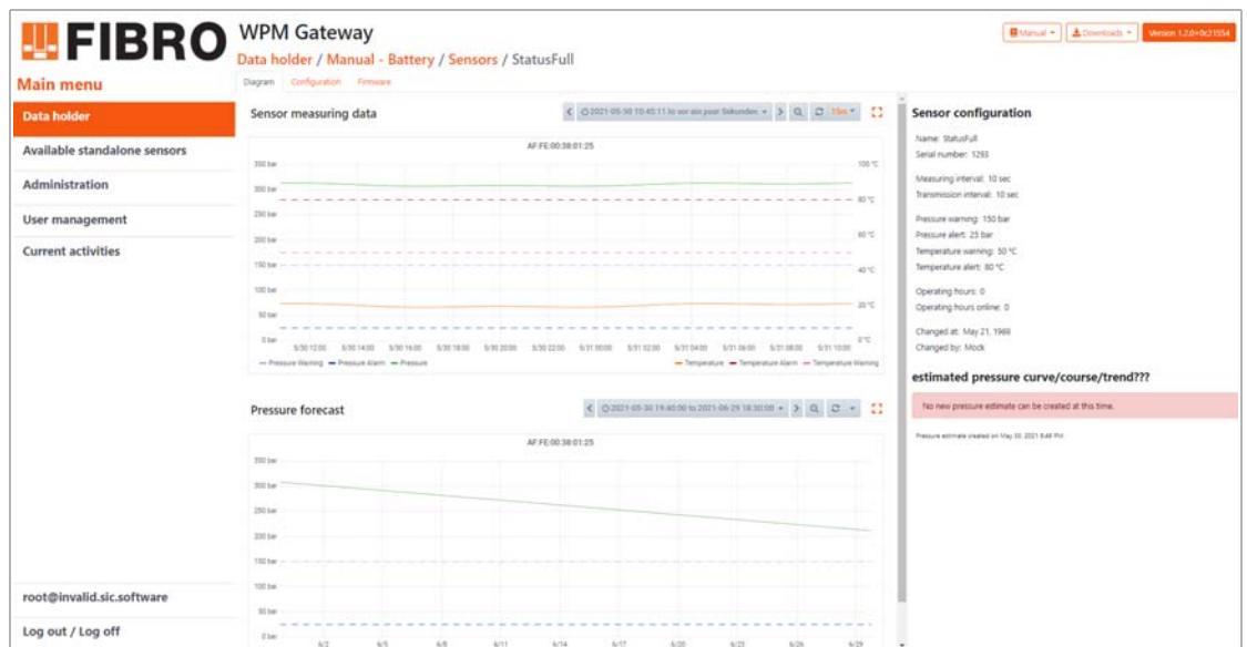
Fig. 7-11 Support de données - valeurs de mesure et prévisions de pression d'un capteur
