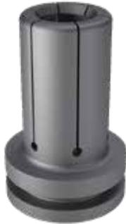
Su geometría es comparable a un manguito expansible (similar a una pinza). Después de la propia operación de estampar, el punzón entra en el DAE con los desperdicios de estampar (pipa) adheridos. Entonces se expande el DAE y se ajusta al punzón de corte. En la carrera de retroceso, el DAE limpia el punzón de los desperdicios de estampar (pipa), protegiendo de daños al útil y al producto.
