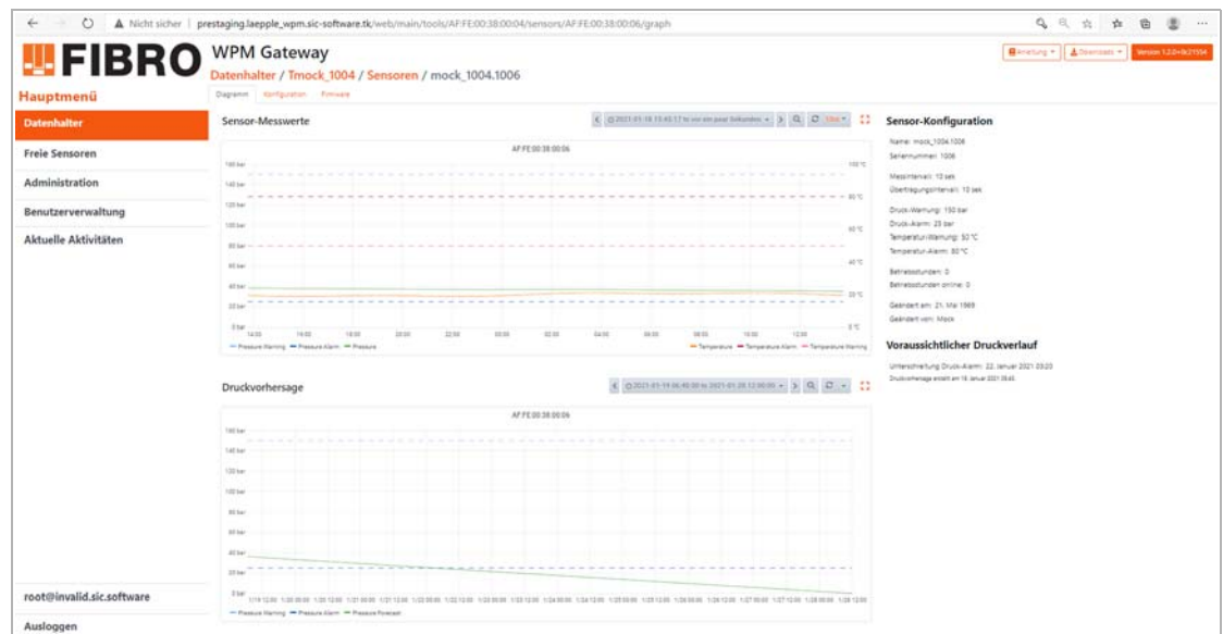
Abb. 7-11 Datenhalter - Messwerte und Druckvorhersage eines Sensors
