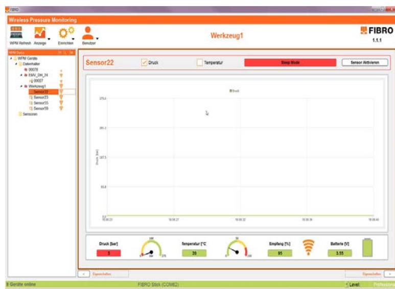
Abb. 6-18 Sensor Messwerte mit der Funktion „Sensor Aktivieren“
