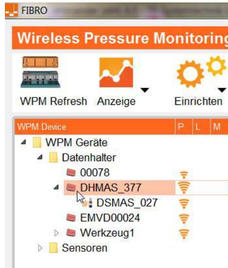
Abb. 7-5 Der Sensor wurde dem Werkzeug hinzugefügt
