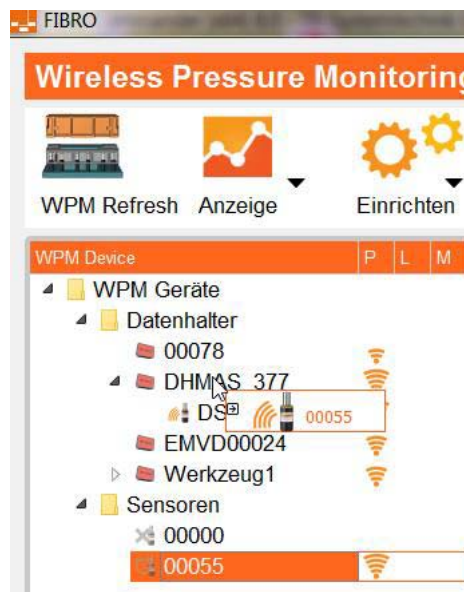
Abb. 7-6 Sensor 00055 wird dem Werkzeug zugeordnet
