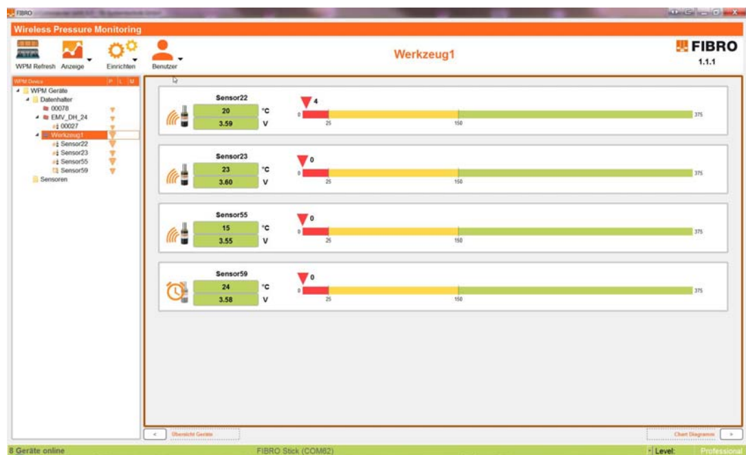
Abb. 6-10 Werkzeug Balkendiagramm mit Live-Daten
